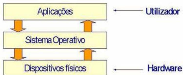
Figura 2.1 – Posicionamento do sistema operativo no sistema
